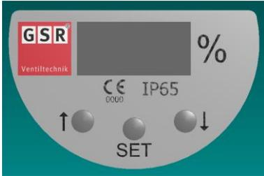
Mit den Tasten "SET", "↑" und "↓" ist es möglich, verschiedene Einstellungen an dem Stellungsregler vorzunehmen. Die Stellungsanzeige zeigt die Ventilposition in Prozent an. Die Position des Ventils ist proportional zu dem Eingangssignal. Das Ausgangssignal zeigt die tatsächliche Ventilposition (IST-Position) des Stellungsreglers an.
